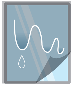
▲窓よりも大きめのシートで 気泡が入らないよう圧着 しながら貼る
