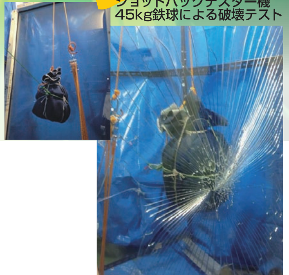
▲破壊後フィルム貼面側…飛散なし
