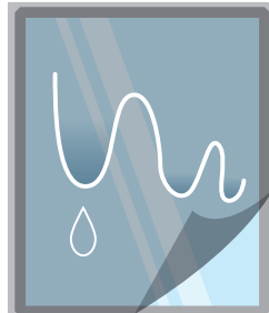
▲窓よりも大きめのシートで気泡が入らないよう圧着しながら貼る
