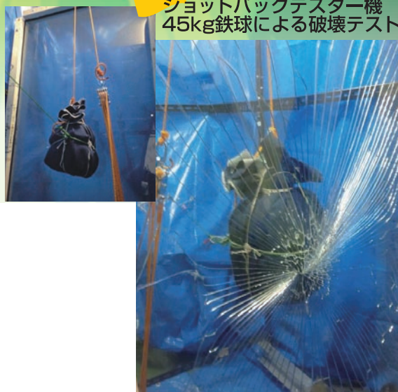
▲破壊後フィルム貼面側…飛散なし
