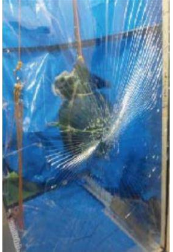
45k鉄球による 破壊テスト前 破壊後、フィルム貼面側・・・飛散ナシ
