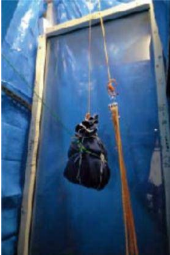
45k鉄球による 破壊テスト前 破壊後、フィルム貼面側・・・飛散ナシ
